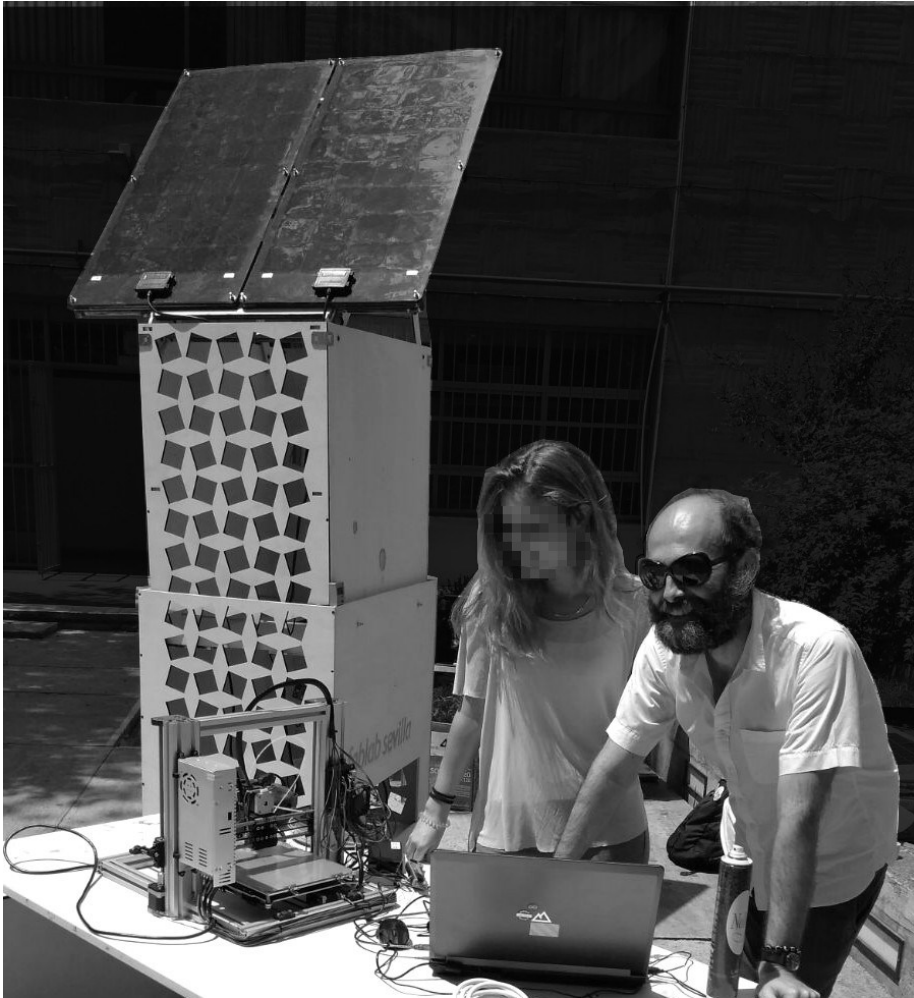
Figura 14: Equipo Fab Lab Sevilla (Cristina Peñas, Jose M. Sánchez-Laulhé, J. Pérez de Lama, Miguel A. López Navarro, Juan C. Pérez Juidías), 2016, prototipo de “fábrica autónoma” impresora 3D fabricada in situ funcionando con instalación de paneles solares fotovoltaicos (Xunzel). Prueba de concepto en el patio de la Escuela de Arquitectura de la Universidad de Sevilla.
